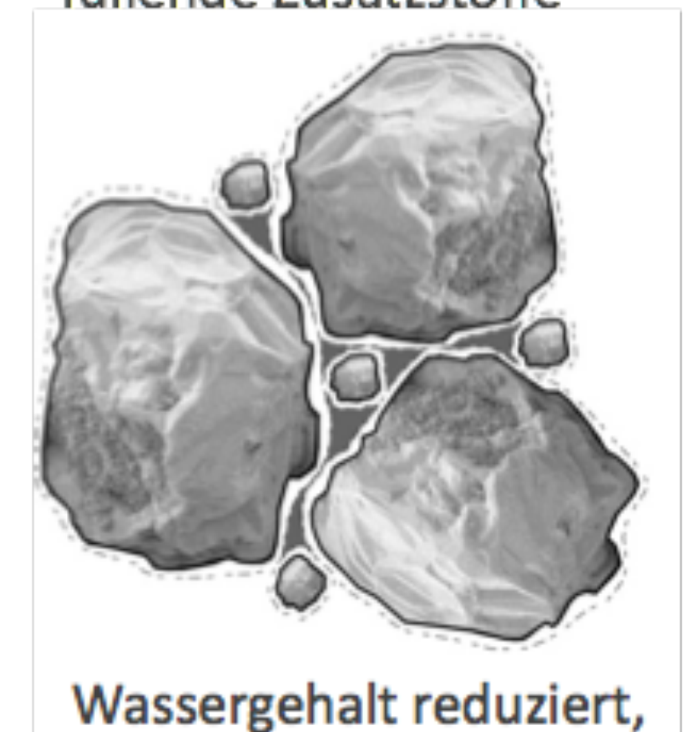
Ersatz des Zements durch Hohlraum füllende Zusatzstoffe
